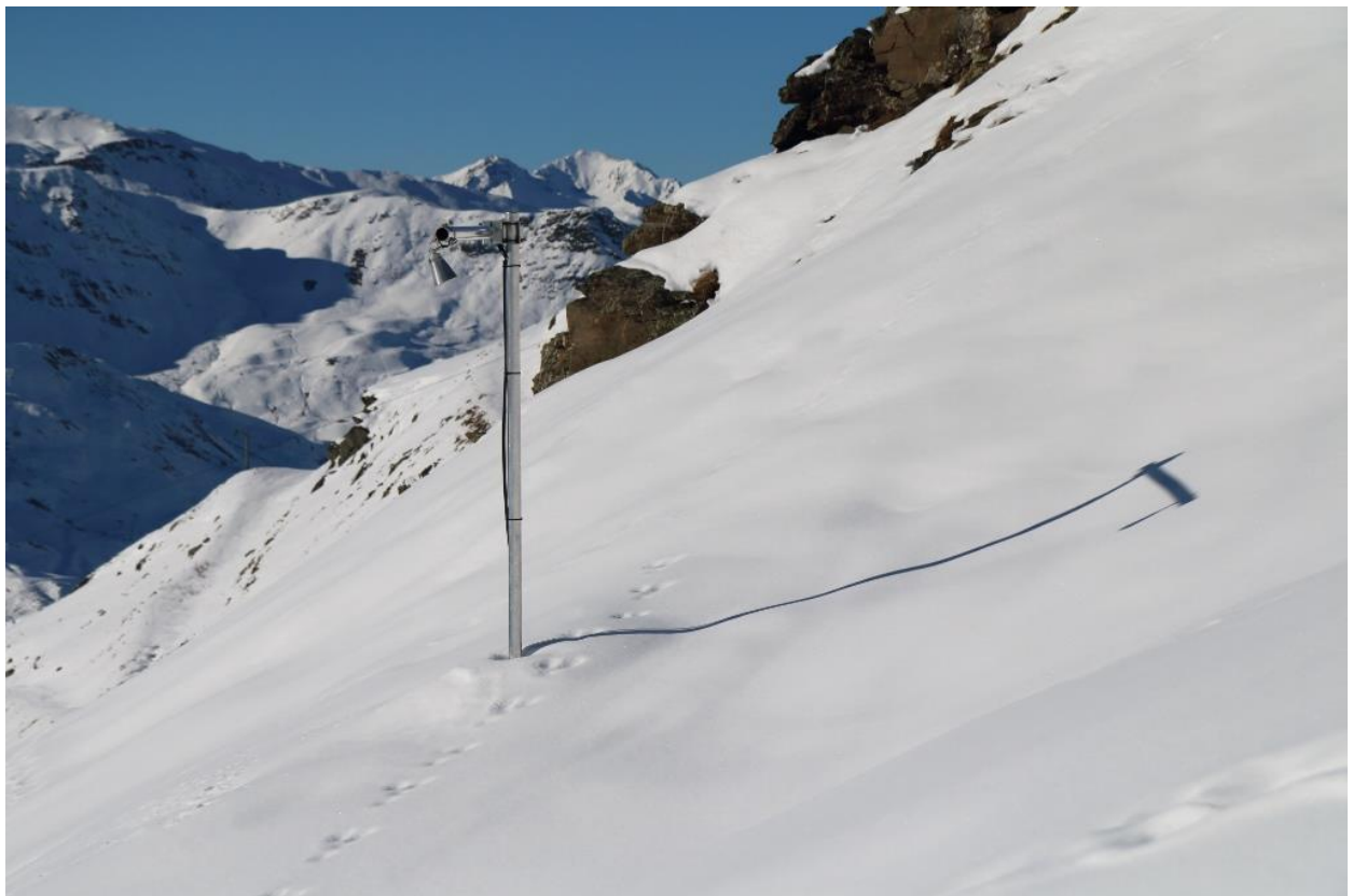
Capteur de hauteur de neige secondaire (point de mesure n°2), en forte pente et en contrebas de la station principale
